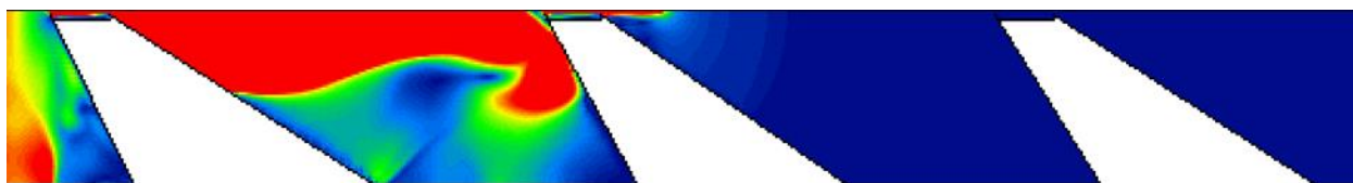
Рис. 12. Экспериментальная модель лабиринтного уплотнения с применением генераторов вихрей
